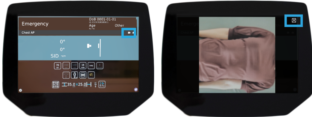
Fig. 3-47 Caméra en direct affichée sur le porte-tube suspendu. Appuyez sur l'icône de la caméra (à gauche) pour l'activer, puis fermez-la en sélectionnant le bouton dans le coin supérieur droit (à droite).
