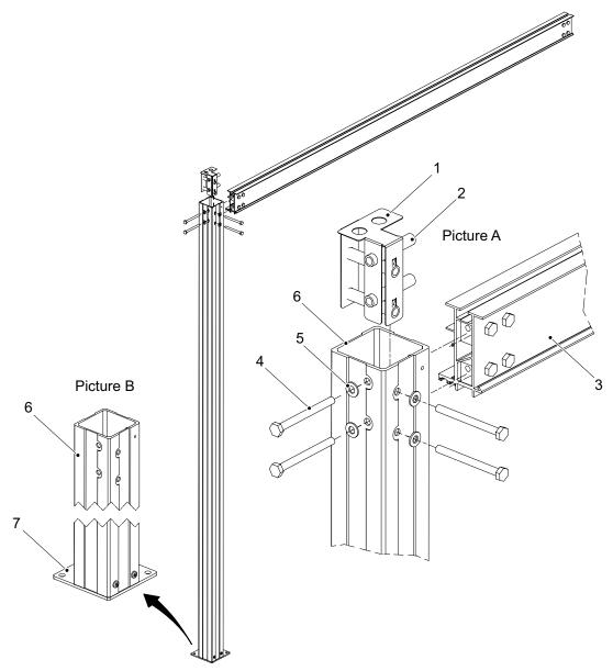
Fig. 10-2 Installing columns
